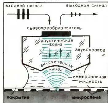
Схема акустического микроскопа.
